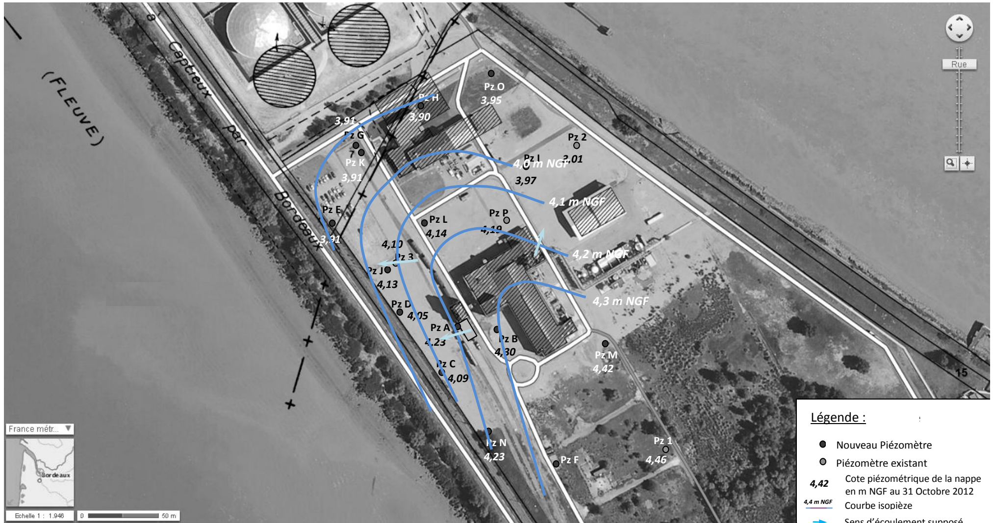
Figure 3 : Esquisse piézométrique de la « nappe » des remblais au droit du site d'étude (mesures d'octobre 2012)
